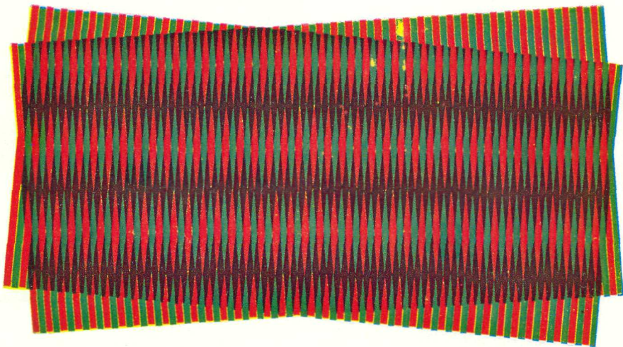
Рис. 9. Расстояния между узлами и расстояния между пучностями уменьшаются, когда угол между бегущими плоскими волнами увеличивается. Поверхность зеркала соответствует узлу на интерференционной картине между падающей плоской волной и отраженной.
