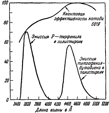
Рис. 1. Спектральная квантовая эффективность фотоумножителя типа 5819 с характеристикой типа S-9 и квантовые эмиссионные спектры двух пластических сцинтилляторов. Для пластмасс, содержащих терфенил и тетрафенилбутадиен, отношение световых выходов равно 1,10, а отношение соответствующих высот импульсов на фотоумножителе — 0,78. Шкала оси ординат произвольна.
