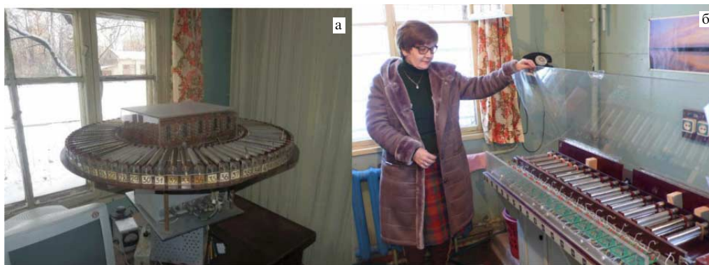
Рис. 3. (В цвете онлайн.) Стенды для градуировки газоразрядных счётчиков СТС-6 (а) и телескопов двойных совпадений (б). Чтобы получить однородные радиационные поля, стенд для градуировки газоразрядных счётчиков вращается с частотой примерно три оборота в минуту.
